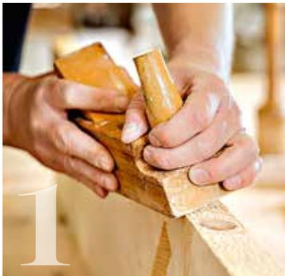
1 Per Schichthobel werden Unebenheiten des Naturmaterials ausgeglichen
