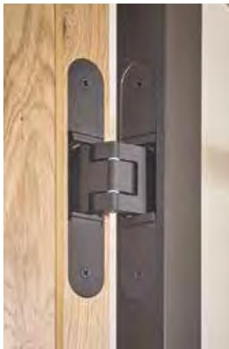
Das innen liegende Tectus-Band erzeugt ein puristisches Erscheinungsbild, da es komplett bündig zwischen Türblatt- und rahmen verschwindet. So fügt es sich geradlinig und flächenbündig in das Gestaltungsprinzip des Minimalismus ein. Darüber hinaus ermöglicht das Tectus-Band eine präzise Justierung des Türblatts. Durch kleine Schrauben lässt sich das Türblatt dafür in Höhe, Seite und Andruck verstellen.
